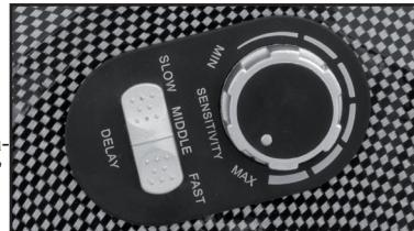
**SENSITIVITY** - Cítivosť snímačov je nastaviteľná otočným ovládačom na pravej strane kukly. Pri zváraní malými prúdmi, obzvlášť metódou TIG, nastavujte maximálnu citlivosť.
